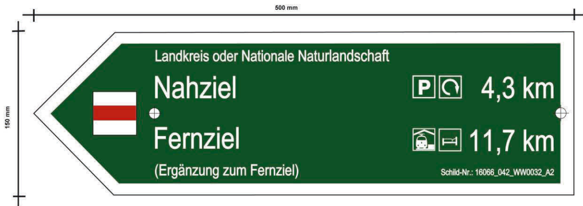
Abbildung 25: Standardwegweiser mit Schraub-Befestigung in der Mitte mit rückseitiger Verstärkungsstrebe
