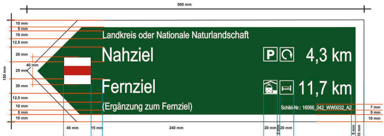
Abbildung 22: Standardwegweiser mit Bemaßung
