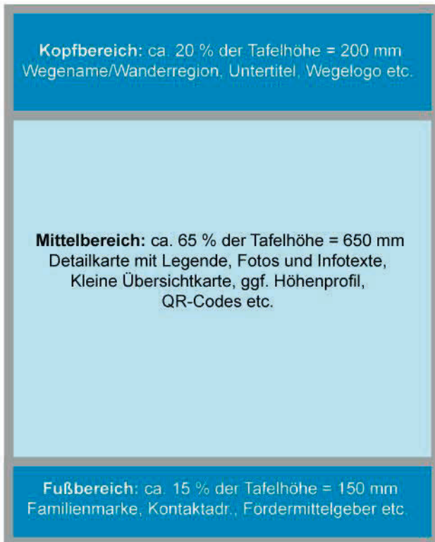
Abbildung 37: Prinzipskizze Anordnung Inhalte Wander-Informationstafel Hoch- und Querformat
