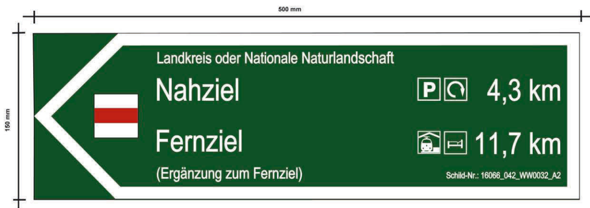
Abbildung 23: Standardwegweiser mit aufgedruckter Spitze zur Nutzung der empfohlenen Hohlkastenprofile
